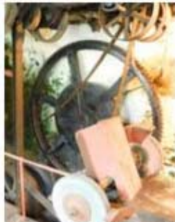
Ohne die Kraft des Wassers, umgelenkt über Wasserräder und Riemen auf die Werkzeuge, wären viele Arbeiten nicht möglich gewesen. (Foto: Kaser)
