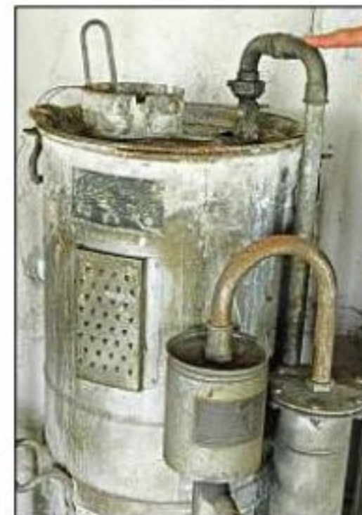
Der Carbidofen war die Basis für die Produktion eines Schweißergases.
