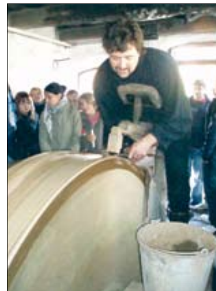
Eine Rarität ist das über Transmission betriebene Schleifrad. Frank Wagenhofer ist es ein Anliegen, die Hammerschmiede Burghausen der Allgemeinheit zugänglich zu machen. (Foto: Hartl)
