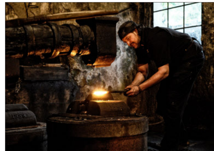
Dreieinhalb Zentner wiegt allein der Metallkopf des schweren Schmiedehammers. Betrieben wird er per Wasserkraft.
