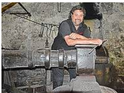
Der leichtere der beiden Hammerköpfe wiegt drei Zentner. Wenn Frank Wagenhofer das Eisen damit bearbeitet, wirken drei Tonnen. – F.: Wetzl
